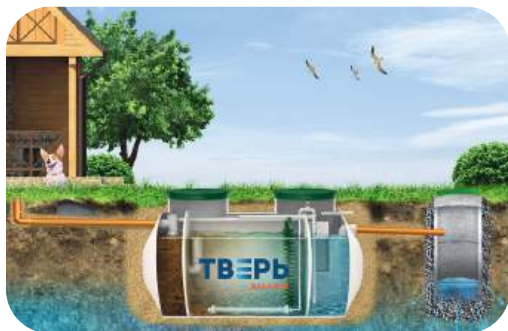
2. Самотечное отведение в приемный дренажный колодец
