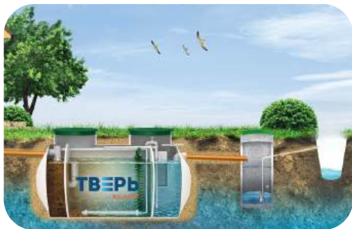
3. Самотечное отведение в приемный накопительный колодец.
