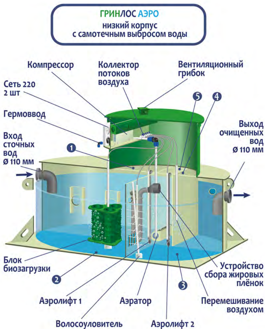
Рисунок 8. Схема Изделия ГРИНЛОС АЭРО с самотечным сбросом (низкий корпус).
