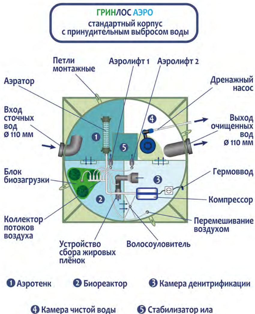
Рисунок 3. Технология очистки стоков в моделях ГРИНЛОС АЭРО с принудительным сбросом (стандартный корпус).
