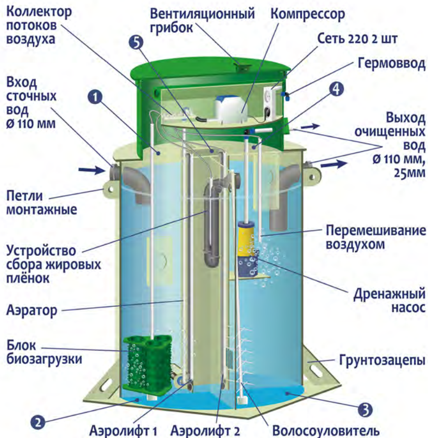
Рисунок 7. Схема Изделия ГРИНЛОС АЭРО с принудительным сбросом (стандартный корпус).
