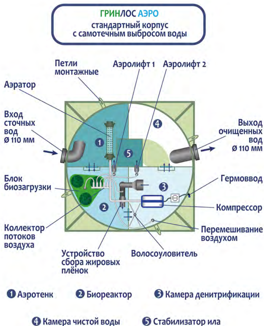
Рисунок 2. Технология очистки стоков в моделях ГРИНЛОС АЭРО с самотечным сбросом (стандартный корпус).
