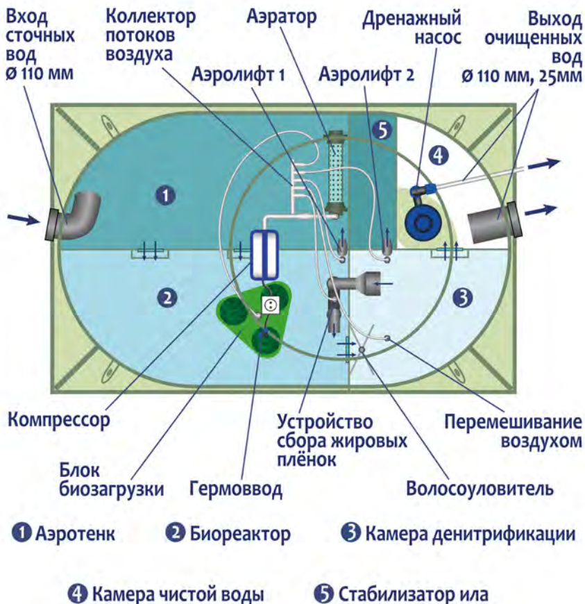
Рисунок 5. Технология очистки стоков в моделях ГРИНЛОС АЭРО с низким корпусом с принудительным сбросом (низкий корпус).
