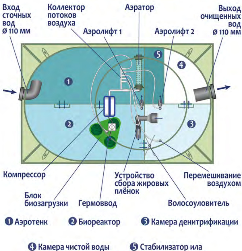
Рисунок 4. Технология очистки стоков в моделях ГРИНЛОС АЭРО с самотечным сбросом (низкий корпус).
