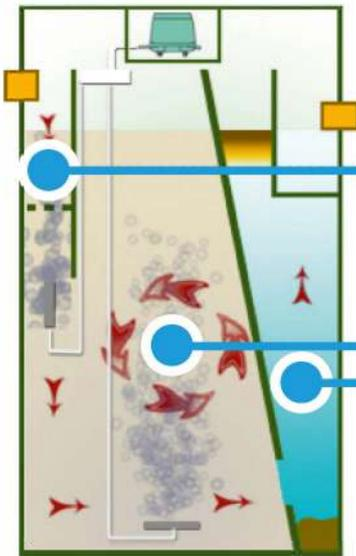
Сточные воды поступают в приемную камеру. Благодаря крупнопузырчатой аэрации и виброэкрану крупные фракции загрязнений разбиваются и перемешиваются до равномерной массы. Сточные воды первично аэрируются.
