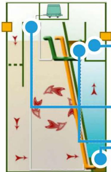
Камера сброса по умолчанию самотёчная. В неё может быть засыпан фильтрующий материал, который может дополнительно повысить качество очистки сточных вод до 2 раз. Также в камере может быть установлен насос принудительного выброса очищенной воды. Комплект для подключения насоса поставляется в комплекте со станцией.
